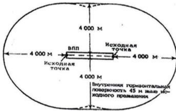
Рис. 4-6 а). Внутренняя горизонтальная поверхность для одной ВПП
